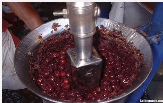
El procesado del asaí para obtener su pulpa comestible involucra labores manuales para la selección del fruto, esterilización y escaldamiento en tanques térmicos que combinan temperaturas extremadamente calientes y frías. | Foto Sol de Pando
